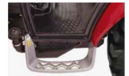
Ebener Boden und große rutschfeste Stufe
