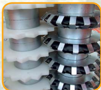
Disco di taglio e stralciatori Cutting disc and press branches barrel Disque de coupe et outils pour l'élagage Schneidescheiben und Abschneider Disco de corte y despampanador
