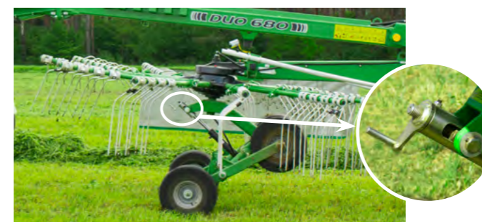
A) Quer- B) Längs Anpassung an das Gelände ermöglicht durch die unabhängige Einstellung beider Kreisel. Zwei Tasträder und zwei unabhängige Rotoren garantieren eine ideale Schwaden der Wiesen, sogar bei den höchsten Arbeitsgeschwindigkeiten.
