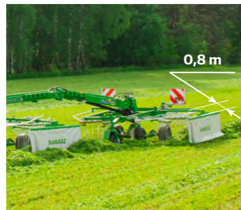
zusätzliches Schwad zum schon gebildeten Schwad (Arbeitsbreite bis 13,6m)
