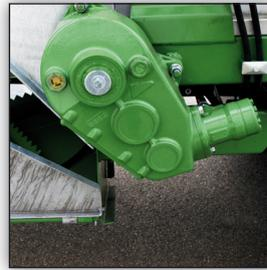
hydraulischer Kratzbodenantrieb mit einstellbarer Vorschubgeschwindigkeit
