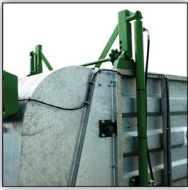
hydraulischer Stauschieber für einfache Produktdosierung
