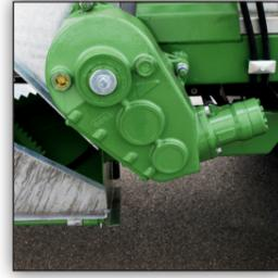
hydraulischer Kratzbodenantrieb mit einstellbarer Vorschubgeschwindigkeit
