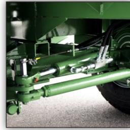
hydraulische Lenkachse für beste Wendigkeit und schmale Vorgehende **auch in Kombination mit Bremsanlage!**
