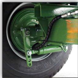
Bremsanlage (hydraulisch oder als 2-Leiter-Druckluftanlage) für steiles Gelände
