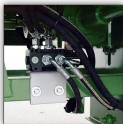
hydraulisches Umschaltventil zur Betätigung von 2 doppelwirkenden Funktionen mit nur einem Steuergerät
