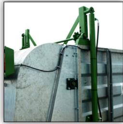
hydraulischer Stauschieber für einfache Produktdosierung
